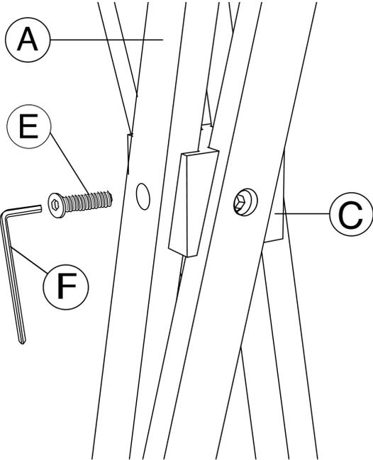
Joindre les pièces A et B à la pièce centrale C
