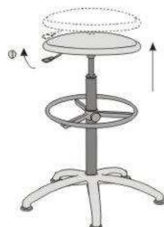
1 Réglage de la hauteur d'assise / Gas height adjustment
